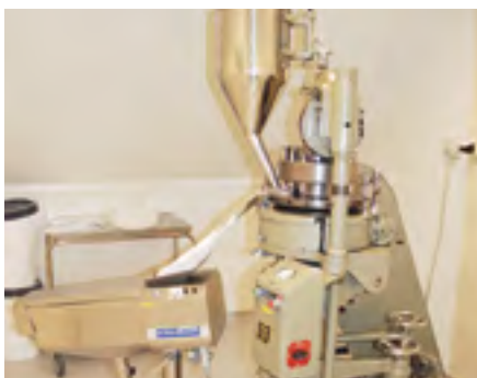
På tablettrommet står Manesty B3B tablettmaskin og tablettavstøver.
