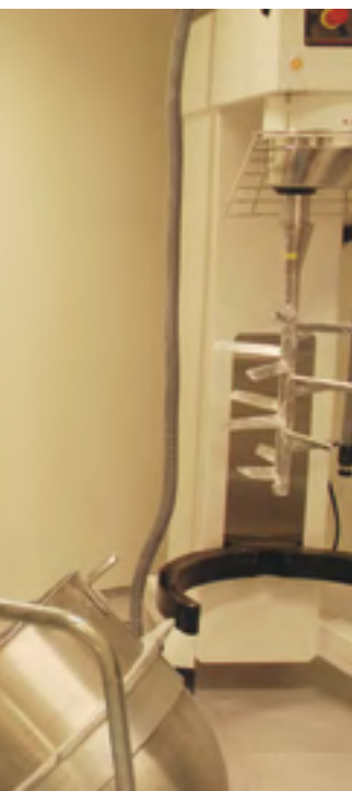
Utstyr for blanding, Bjørn Ergo granulerer på maskinen Unimil. (Alle foto: Laura Kvalo Petersen, Kragerø Tablettproduksjon AS)
